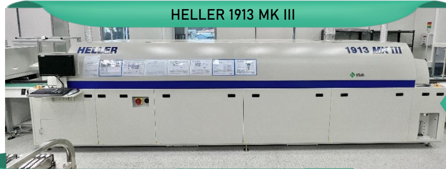
HELLER 1913 MK III 15 Zone 질소 리플로우 [질소 공급으로 인한 산화방지 열화데미지 방지 시스템]
